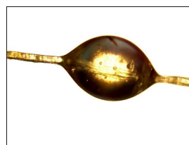
5. ábra. Polipropilén csepp kenderszálon és a cseppelehúzás elve
