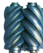
5. ábra. Csavarkompresszor kialakítása
