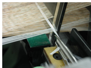
11. ábra. A vetülék elengedése az átvevő fogófej által
