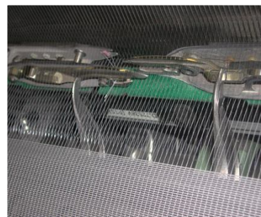
3. ábra. Vezérelt vetülékátadás
