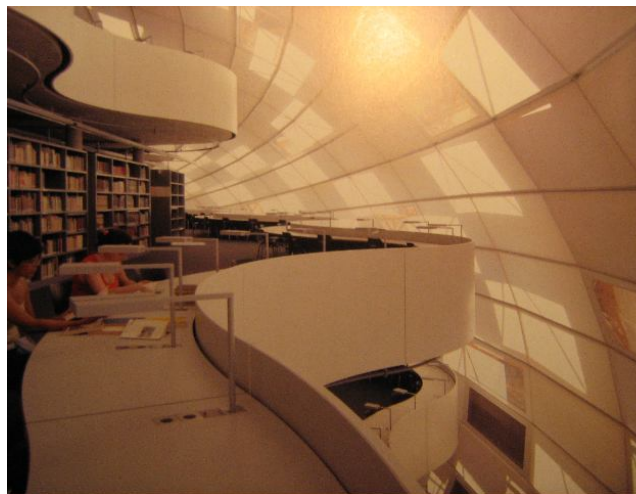
A Berlini Egyetem könyvtárának alumínium és üveg tető-szerkezete alatt található ez a különleges sátor, amely átengedi és szűri a fényt, egyszersmind szigetel és lehetővé teszi, hogy télen-nyáron nappali fénynél olvassanak a hallgatók.
