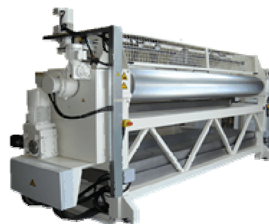
4. ábra. Habréteg felvitelére alkalmas fulár
