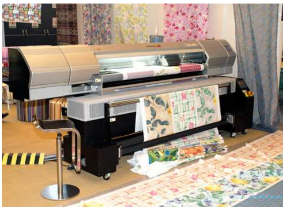
1. ábra. Felületkezelésre is alkalmas digitális textilnyomó gép
