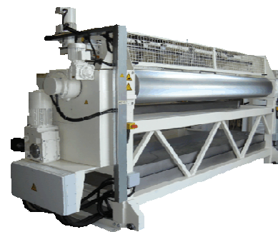
4. ábra. Habrétegelő felvitelére alkalmas fulár
