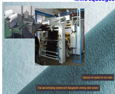
6. ábra Kenés vésett hengerrel
