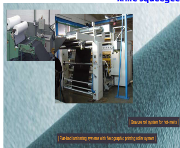
6. ábra Kenés vésett hengerrel
