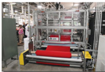
10. ábra. Textília plazmakezelése
