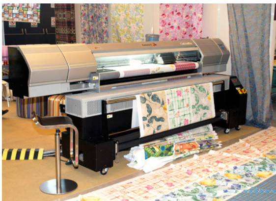
1. ábra. Felületkezelésre is alkalmas digitális textilnyomó gép
