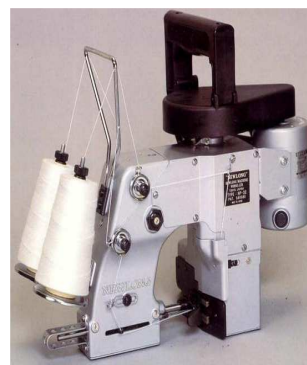
15. ábra. Kéttűs kétfonalas láncöltésű zsákszáj bevarró gép [8]
