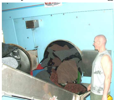
A szőnyeget a mosógépből egy szállítószalagra engedik...
