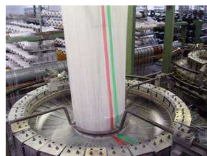
7. ábra. Polipropilén körszövött zsák készítése
