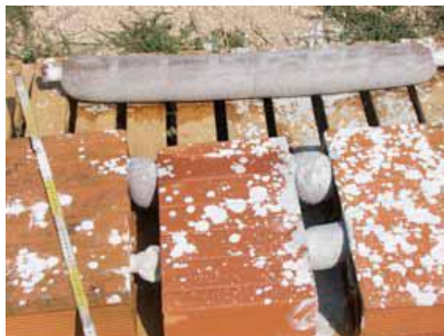
4. ábra. Betonnal töltött körkötött csőkelme
