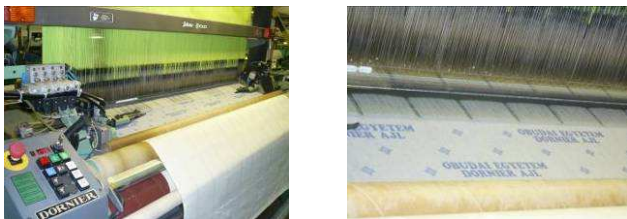
11. ábra. Vetülékbevetési hiba miatt leállt légsugaras szövőgép
