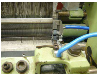
8. ábra. A feszítőfűvóka és a vetülékörök
