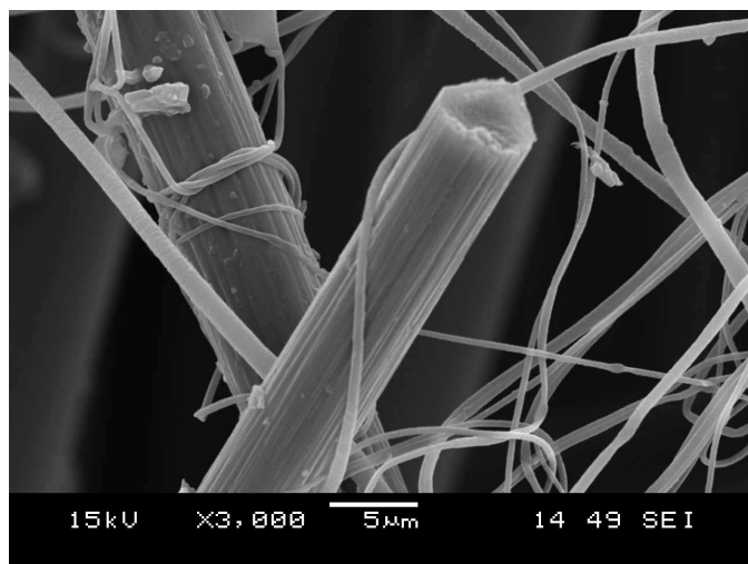
8. ábra. Szénszálak és PAN nanoszálak pásztázó elektronmikroszkópi képe [28]
