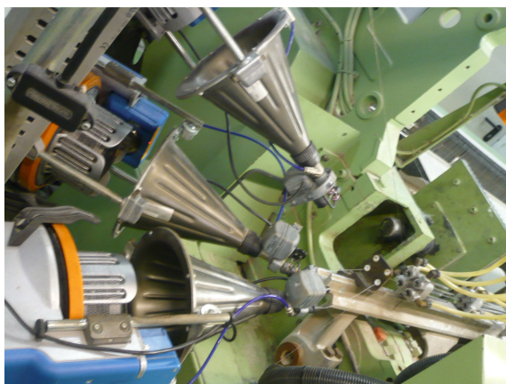
6. ábra.. Légsugaras szövőgépre szerelt Roj Super Elf vetüléktárolók elhelyezése
