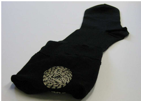
3. ábra. Elektromosságot vezető szálak tartalmú harisnya lábszárfejkély elektromos stimulálására
