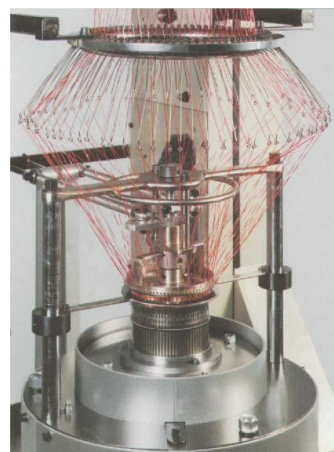
A láncrendszerű körkötőgép kötőfeje (Rius)
