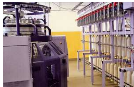
Körkötőgép a csévetartó állványra szerelt fonóegységekkel (Terrot)
