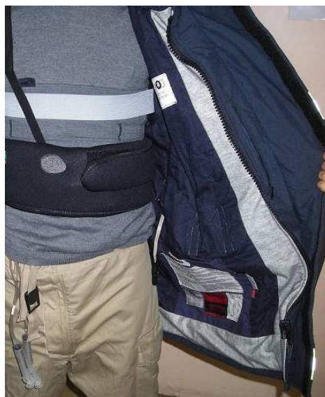
2. ábra. A PROETEX védőruha belső rétege
