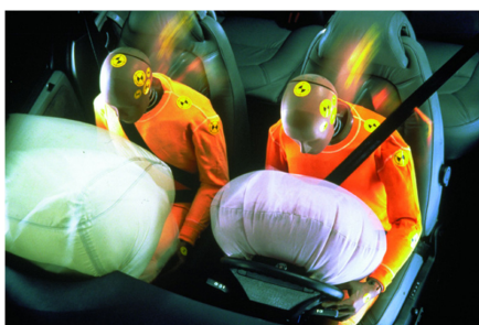
7. ábra. Légzsákok és biztonsági övek tesztelése
