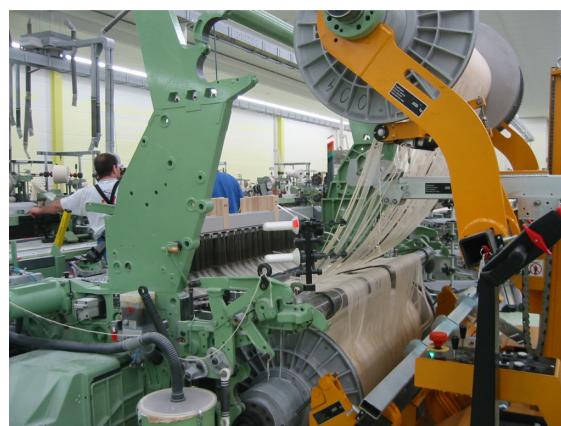
11. ábra. Párhuzamos elrendezésű láncengerek és azok cseréje
