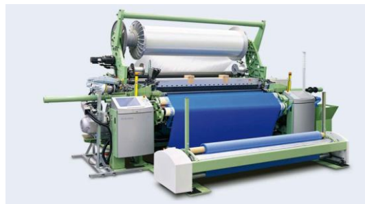
1. ábra. Korszerű kelmefelvétel megoldása szövőgépen
