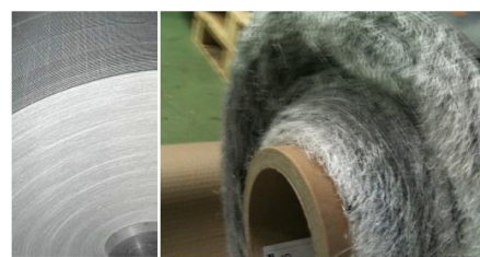
9. ábra. A helyes és az elcsavarodott tekercs homlokfelülete [5]
