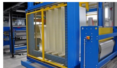
14. ábra. Folyamatos működés megvalósítása puffer-tárolóval [8]
