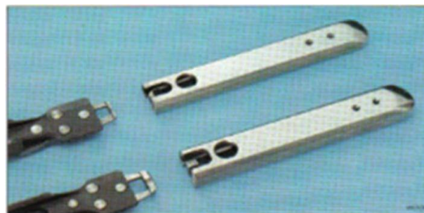
13. ábra. A D1 és D2 fogóvetélő és a vetülvégfogók
