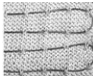
Síkkötött kelmébe befektetett fűtőszál (Stoll)
