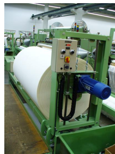
11. ábra. Dörzs- és tengelyhajtás együttes alkalmazása [5]
