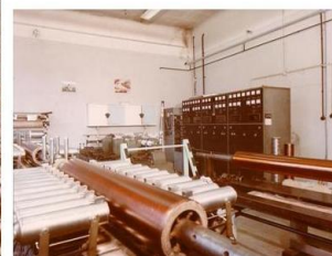
Nyomóhenger-készítés elektromos pantográfval
