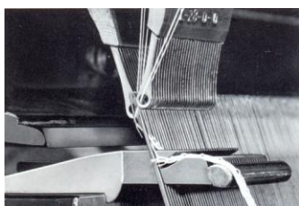
15. ábra. Horgas tűvel működő lánchurkológép szemképző eszközei [28]
