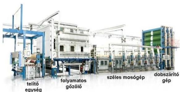
A pad-steam folyamatos színező gépsor felépítése
