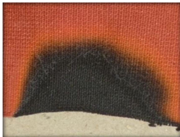
3. ábra. Makro felvétel a szélgyújtás során károsodott anyagról
