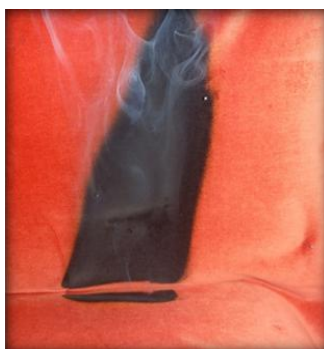
17. ábra. FLACAVON B45 nagy lángos teszt eredménye
