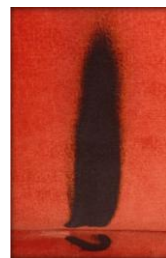
12. ábra. A LÁNGTEX F1 kislángos teszt végeredménye
