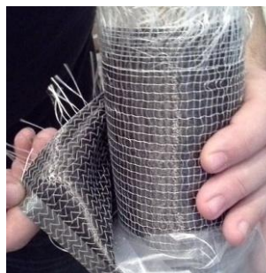
Szénzálás kompoziterősítő a Puli holdjáróhoz [4]
