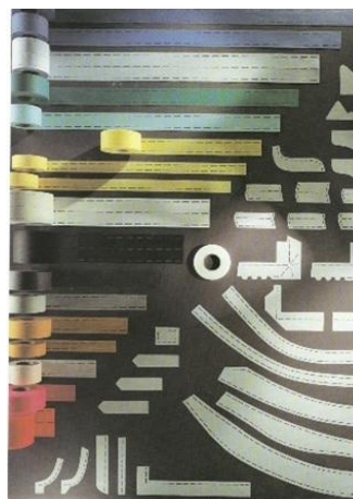
6. ábra. Kivágópréssel készített alkatrészek
