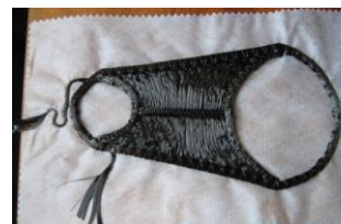
Kompozit gépalkatrész textil-erősítése hímzőgépen előállítva
