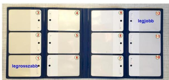
Műanyaglapos etalonsorozat fehérségi mérték ellenőrzéshez
