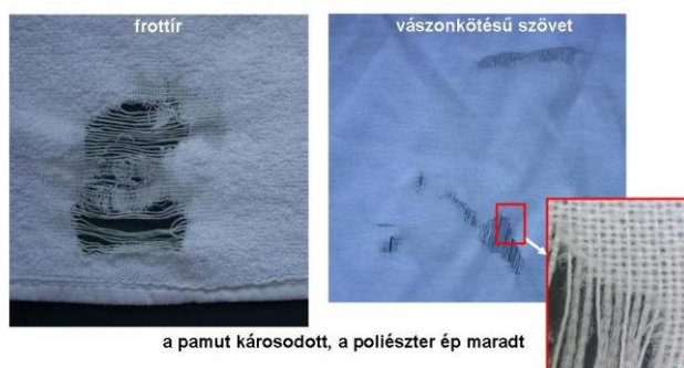
Pamut, poliészter fonalakból készült textíliák helyi savas károsodása
