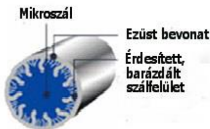
2. ábra. Ezüst nanorészecskékel bevont mikroszál keresztmetszete [6]
