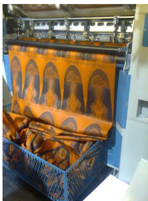
Cipőfelsőrészek készülnek két tűágyas raschel-gépen (Santoni)
