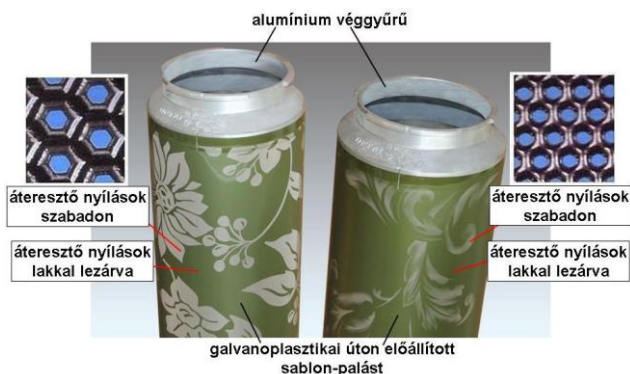
A rotációs filmnyomó-sablon felépítése
