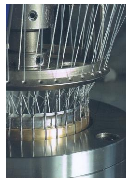
Kör-lánchurkológép 2 fonalvezető gyűrűvel
