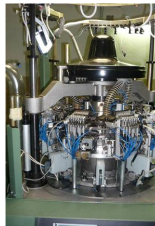
Egybekötött ruhadarab készítésére szolgáló körkötőgép kötőfeje (Santoni)
