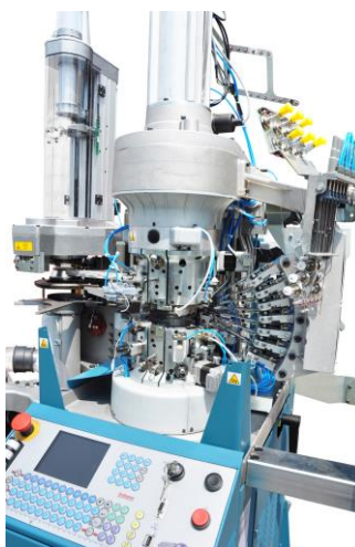
Lonati DC 88 zoknikötőgép automatikus orrhegy- bevarrással
