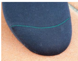
A kötőgépen készített orrhegy-bevarrás (Busi)
