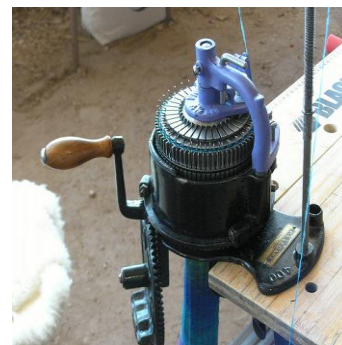
8. ábra. Két tűágyas kézi körkötőgép harisnyaszár készítésére
