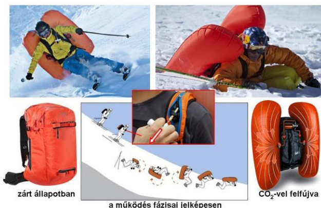
A lavinaomlásokkor működésbe hozható életmentő légszák
