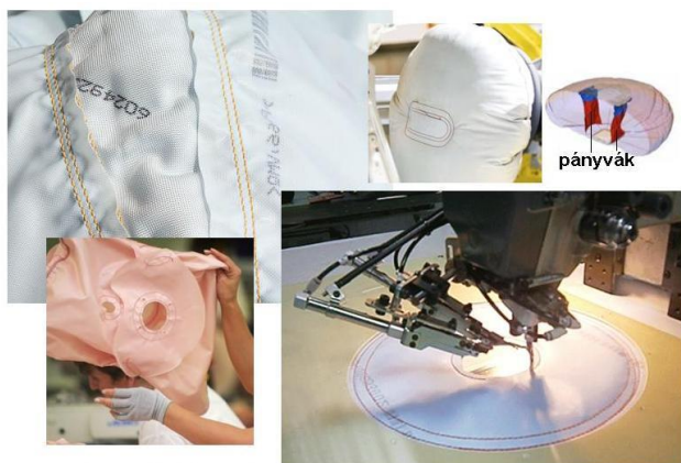
A légszák kialakításának néhány varrási művelete
