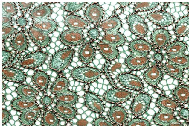
19. ábra. Elektronikus jacquard-mintavezérlésű csipke-raschelgépen készült csipke
