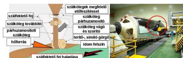
Kompozit vázerősítő szerkezet kialakítására példa a repülőgép gyártásban
