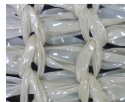
fóliafonalból raschelgépen kialakított mikrohézagos hurkolt kelmé
