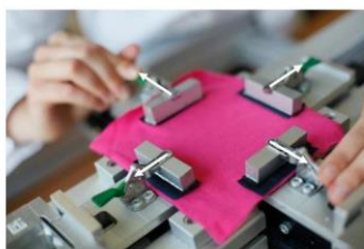
A textilminta feszítése a használatnál bekövetkező megnyúlás imitálására, ami szerkezetritkulással jár
