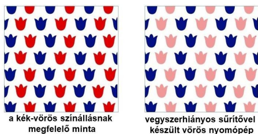
Példa a vegyszerhiányos nyomópép következményére 16. ábra
