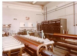
Nyomóhenger-készítés elektromos pantográffal
