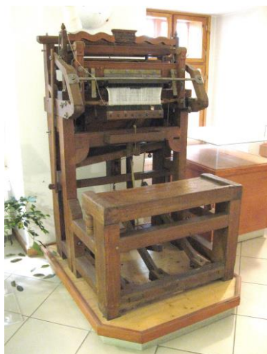
Lee-rendszerű kötőgép a hajdani Kokron-gyárból
