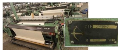
a 2-190-es, 190 cm-es bordaszélességű gép és adattáblája
