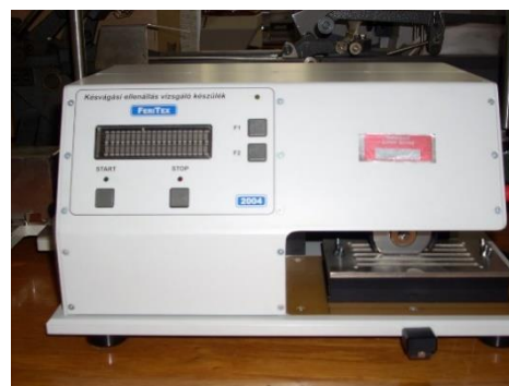
2. ábra. A késvágás mérőszere az INNOVATEX Zrt. laboratóriumában
