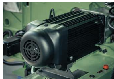
2.8. ábra. Dornier légsugaras és vető- lékvivős szövőgép főtengelyére erősített főmotor
