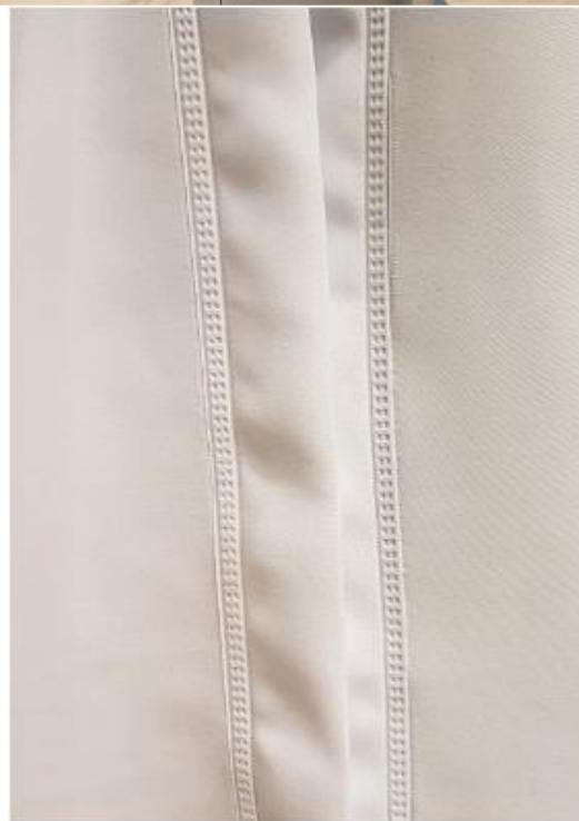
11. ábra. NUCLEUS ultrahangos hegesztőgép és a varratkép (saját fotó)
