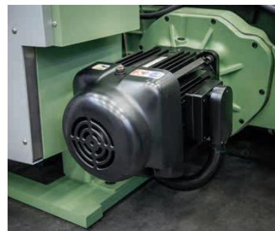
2.9. ábra. SyncroDrive szövőgép hajtás a szádképzők külön motorhajtással
