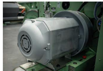
2.7. ábra. Dornier légsugaras és vető- lékvivős szövőgépek meghajtása CompactDrive motorral
