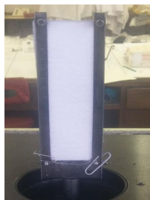
2. ábra. Az előkészítés során használt eszközök és a minta felhelyezése a vizsgálóberendezés keretébe. A minta égése a gyújtóforrás elvétele után
