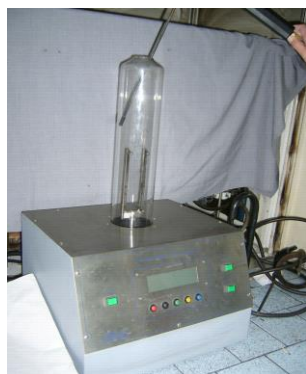
1. ábra. Az oxigénindex mérő készülék felépítése és a készülék (Ybl Kar, Tűzvédelmi labor)
