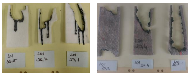
3. ábra. Vizsgálat során meggyújtott poliészteranyagok égése különböző oxigén tartalomban
