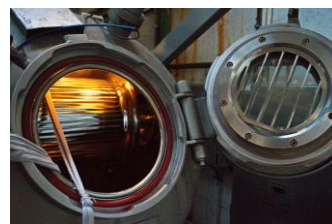
Kezdődik a kelme befűzése a Soft Stream színezőkészülékbe
