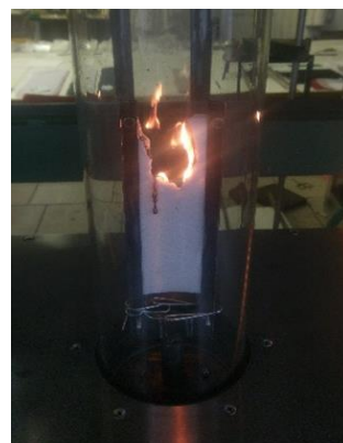
2. ábra. Az előkészítés során használt eszközök és a minta felhelyezése a vizsgálóberendezés keretébe. A minta égése a gyújtóforrás elvétele után
