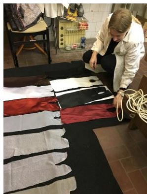
8. ábra. Sugárzó hőnek kitett minták
