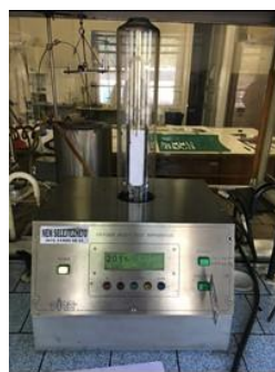
1. ábra. Oxigénindex mérő készülék és elvi felépítése az Ybl Miklós Építéstudományi Kar tűzvédelmi laboratóriumában
