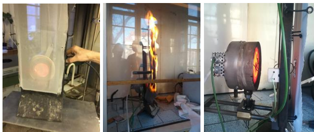
5. ábra. Vizsgálat sugárzó hővel MSZ ISO EN 13773 szerint
