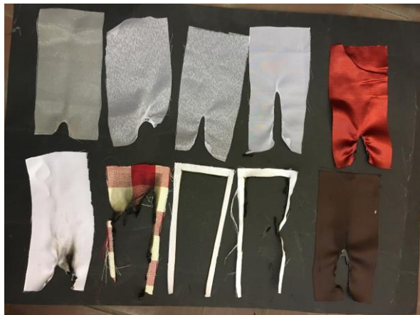
6. ábra. Kis lángos teszt eredményei P jelű anyagokon
