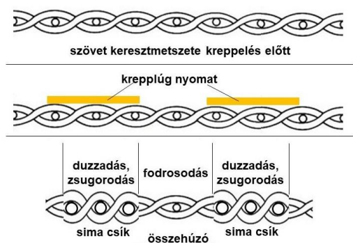
A lúgnyomott krepphatás kialakulásának elvi ábrázolása
