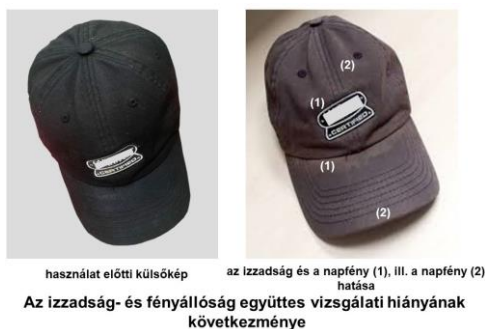
Izzadságállósággal kombinált fényállóság vizsgálat
