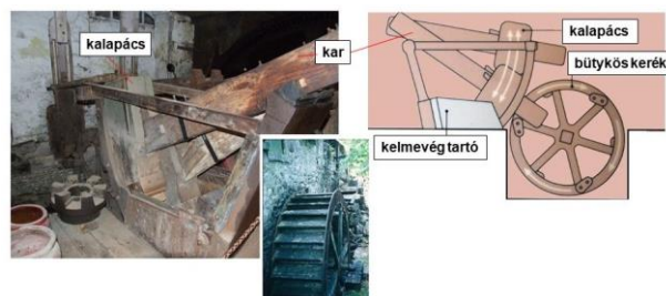
Víziergiával működtetett kalapácsos ványológép
