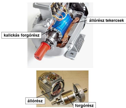
A kalickás forgórészes váltakozóáramú motor felépítése
