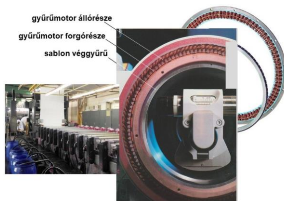
„Direct Drive” sablonhajtás gyűrűmotorral a rotációs filmnyomógépen
