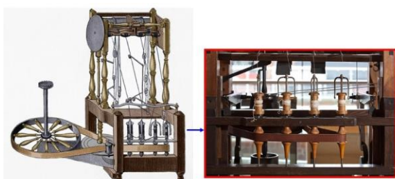
„Water Frame”, a víziergiával hajtott szárnyasorsós fonógép
