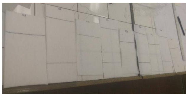
1. kép. A minták előkészítése a lángterjedési teszthez
