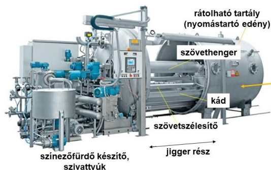
A HT-jigger felépítése
