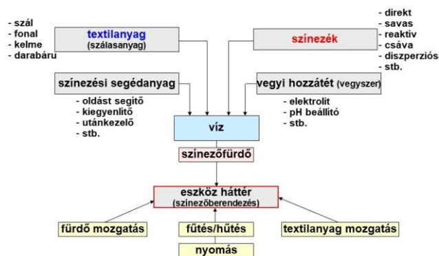
A textil színezőrendszer összetevői
