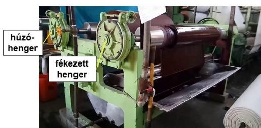
Hagyományos nyitott jigger működés közben 11. ábra
