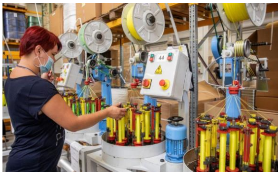
Munkában a fonatológépek (Fotó: MTI/Rosta Tibor)
