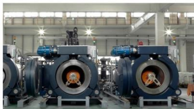
Szuperkritikus széndioxiddal működő színezőberendezés 21. ábra
