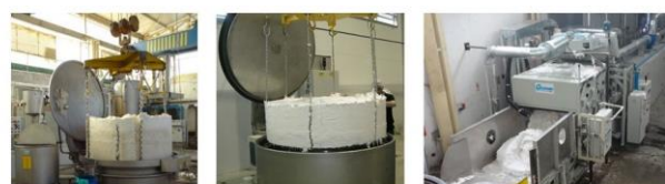
laza szálanyag fehérítése, centrifugálása és szárítása
