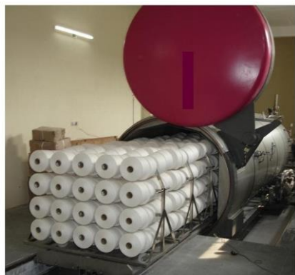
Keresztcséve kiszerezésű fonalak kondicionálására alkalmas berendezés
