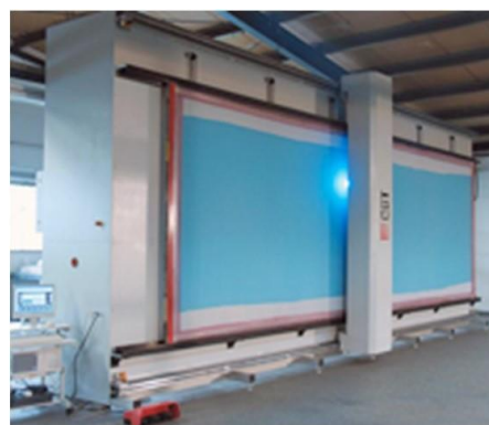
A DLE (Digital Light Engraving) technológiával történő sablonkészítés
