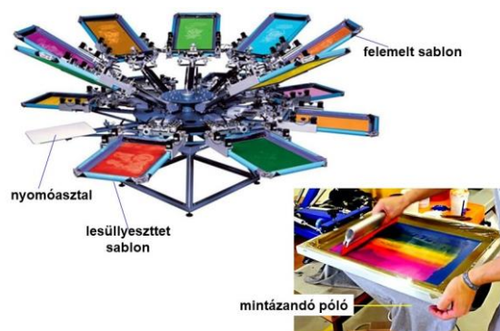
Karusszel rendszerű szitanyomógép darabáru mintázáshoz
