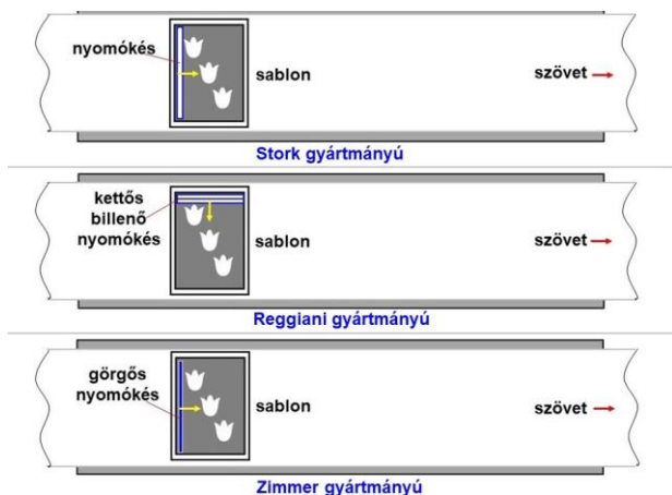
Késtípusok és -mozgatás a különféle síkfilmnyomógépeken
