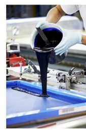
nyomópép betöltése a sablon holtterébe
