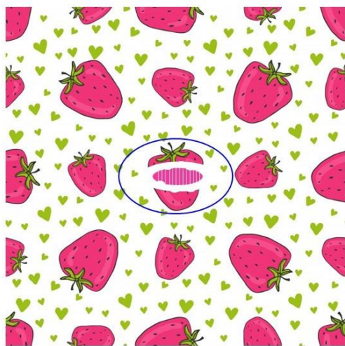
Vetülékbefutás okozta nyomóhiba
