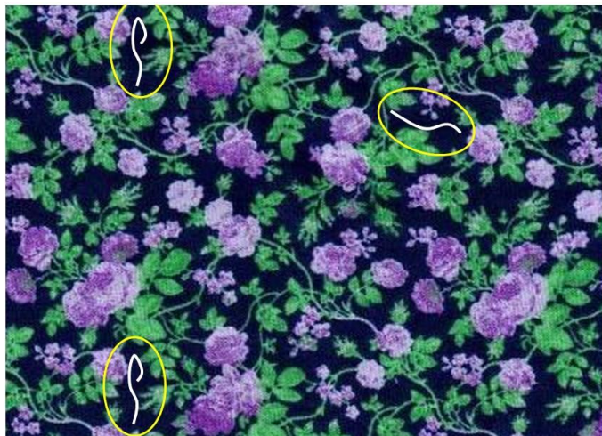
A sablonra - levált - fonaldarab feltapadása miatti, fordulatra ismétlődő nyomópép kimaradás
