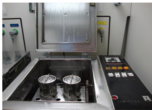
6. ábra. Original Hanau Linitest 7421 laboratóriumi színező berendezés
