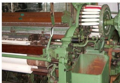
vetelő szövőgép (csévéváltós automata)
