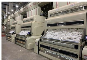
az egrenálás műveletével a szál leválasztása a magról → pamut
