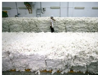
a pamut szálhalmaz előkészítés bálázásra
