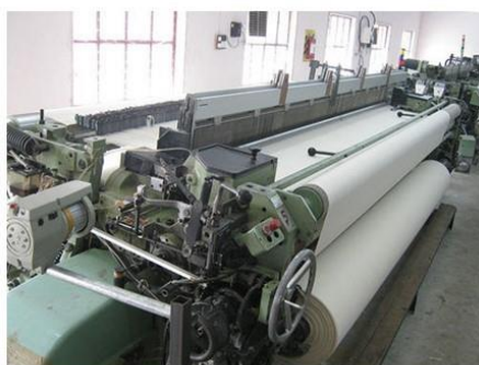
vetelőnélküli szövőgép (fogóvetelő)
