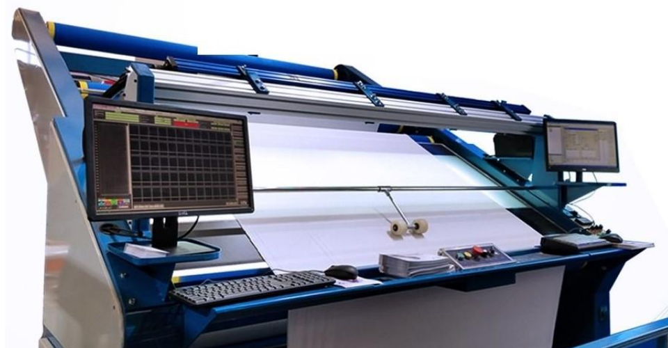
online kamera, maximum 80 m/min átnézési sebesség, hibadetektálás 0,15 mm mérettől
