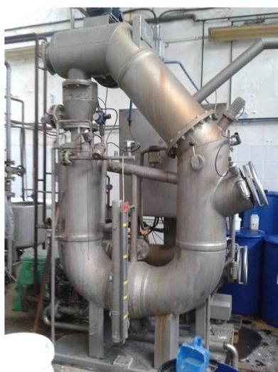
Kis tétel kötegállapotú színezésére alkalmas színezőberendezés a festődében
