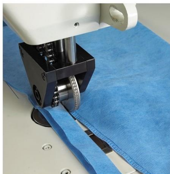
nemszöttkelme rétegek ultrahangos egyesítése
