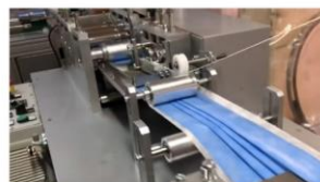
3. Szélek hegesztése, darabolás, ornál formáló szalag bevezetése
