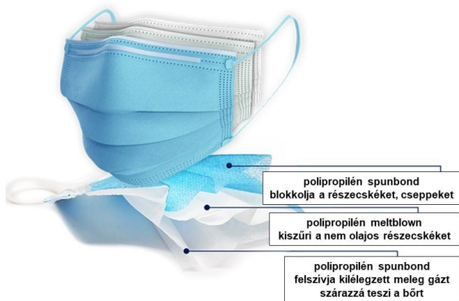
Többretegű maszk szerkezete
