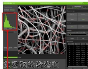
a szálátmérők histogramja szálak átmérője az 1-3 \mu\text{m} tartományban legyen a piros körök azt a távolságot jelzik, amelyen keresztül a Fibermetric Software megmérte a szál átmérőjét
