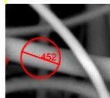
a szálátmérők histogramja szálak átmérője az 1-3 \mu\text{m} tartományban legyen a piros körök azt a távolságot jelzik, amelyen keresztül a Fibermetric Software megmérte a szál átmérőjét
