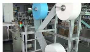
1. nemszött rétegek összevezetése
