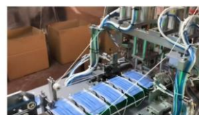
6. rögzítőgumik hegesztéses rögzítése
